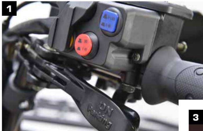
**1** GOES i-Diff (elektronisch zu 100% sperrbares Differential) vorne und hinten, Feststellbremse
